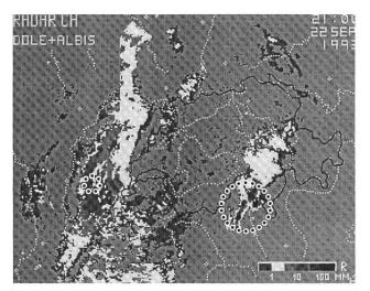
Bild 4. Kompositbild der Niederschlagsradare La Dôle und Albis vom 22. September 1993, 21.00 Uhr, wie es zur Kürzestfristprognose beigezogen wird. Die gepunkteten Kreise umfassen Gebiete mit starken Niederschlägen. Die Starkniederschlagszone westlich des Genfersees verlagerte sich bis zum 23./24. September in Richtung Walliser Alpen und bewirkte dort die verheerenden Überschwemmungen in den Seitentälern der Rhone (nach *Lang* et al., 1996 verändert).
