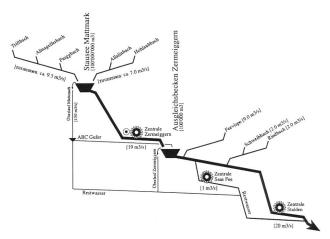
Bild 7. Schematischer Überblick der Kraftwerksanlage Mattmark [in eckigen Klammern sind die Kapazitäten der einzelnen Elemente aufgeführt] (aus Meteodat, 1999).
