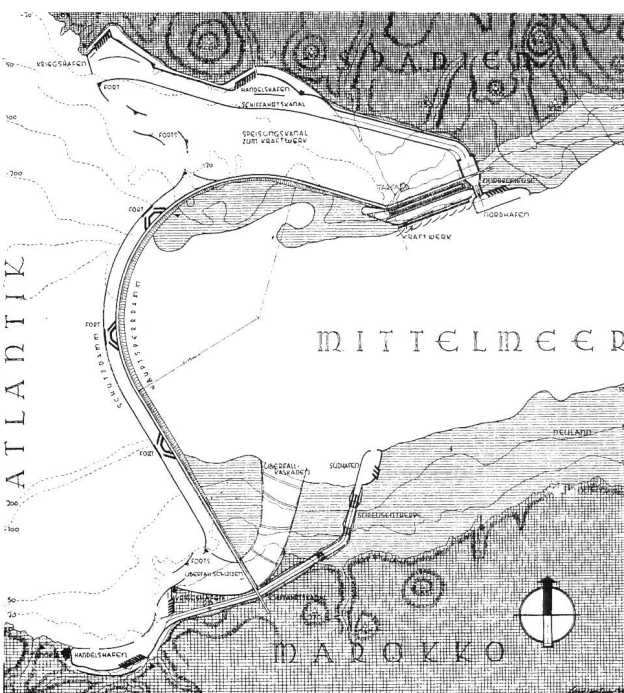
Bild 1. Staudamm bei Gibraltar, der dem Mittelmeer das Wasser entzogen hätte.
