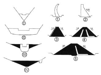
Bild 6. a) Talformen: (I) Kerbtal, (II) Trogtal, (III) Canyon plus Muldental, (IV) Muldental; b) Talsperrentypen: ① Doppelt gekrümmte Bogenmauer (Kuppelmauer), ② Gewichtsstaumauer, ③ Steinschüttdamm mit Betonoberflächendichtung, ④ Steinschütt-Zonendamm, ⑤ Erdschüttdamm mit Oberflächen- oder Innendichtung.
