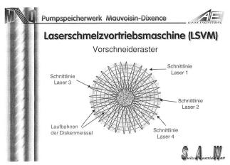
Bild 10. Vorschneideraster der Laserschmelzvortriebsmaschine.
