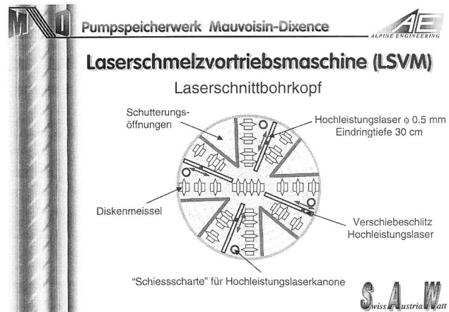
Bild 9. Bohrkopf der Laserschmelzvortriebsmaschine.
