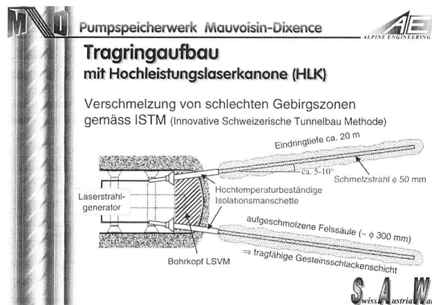
Bild 11. Gebirgsverfestigung mit Hochleistungslaserkanone.
