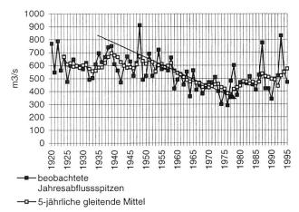
Bild 2. Jährliche Abflussspitzen und zugehörige 5jährliche Mittel, Rhône in Sion
