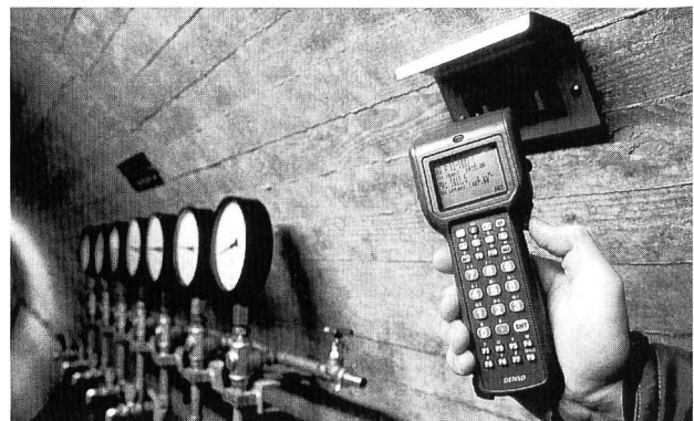
Bild 5. Handheld-Computer zur automatisierten Erfassung von Handmessungen und zur Identifikation der Messstellen mit integriertem Strichcodeleser.
