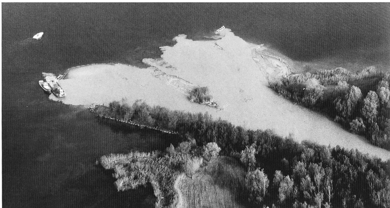
Bild 5. Das Aa-Delta im Zürichsee. Bei Hochwasser und Spülungen taucht der Trübestrom rasch ab.
