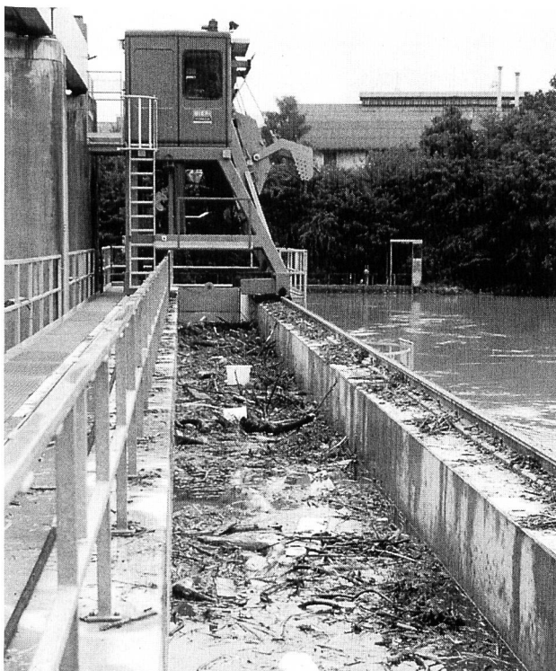
Renchérissent le prix de l'électricité et sont entre-temps jugés problématiques en termes biologiques: la récupération et le traitement des déchets flottants (naturels) sur les centrales au fil de l'eau.
