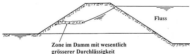
Bild 6. Erosion im Inneren des Damms, verursacht durch eine Dammzone mit zu grosser Durchlässigkeit (Filterkriterien zwischen dieser Zone und dem Damm nicht eingehalten).
