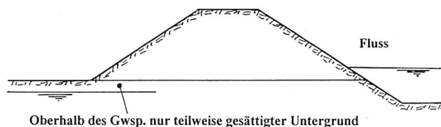
Bild 7. Oberste Zone des Untergrundes nur teilweise gesättigt bei «normalem» Wasserspiegel im Fluss. Bei Anstieg auf Hochwasserniveau rascher Anstieg des Grundwasserspiegels bis Oberkante Boden.
