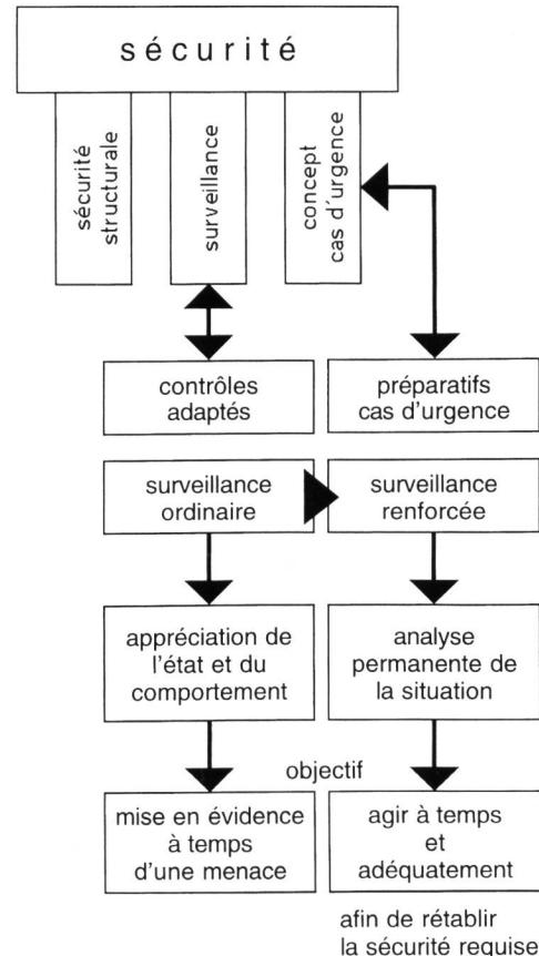
Figure 12. Correspondance entre la surveillance ordinaire et la surveillance renforcée.
