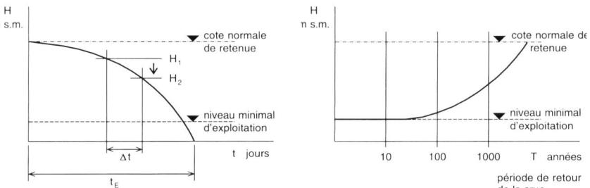
Figure 18. Temps nécessaire pour abaisser partiellement ou totalement le plan d'eau d'une retenue (vidange de fond complètement ouverte).
