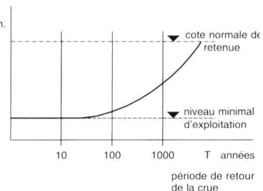
Figure 19. Remontée du plan d'eau provoquée par une crue atteignant une retenue dont le plan d'eau était préalablement abaissé (vidange de fond complètement ouverte).
