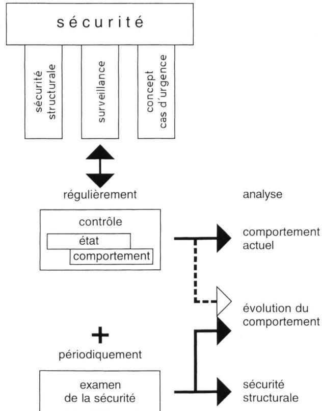
Figure 6. Eléments de la surveillance et objectifs.
