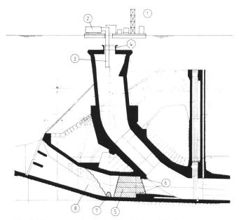
Bild 3. Längenprofil durch den Gundablasseinlauf.
