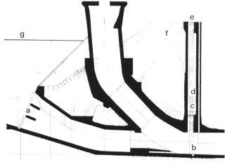
Bild 6. Gewebeschalungselement. Frontansicht mit Injektionsanschlüssen und Auftriebselementen als Positionierungshilfe.
