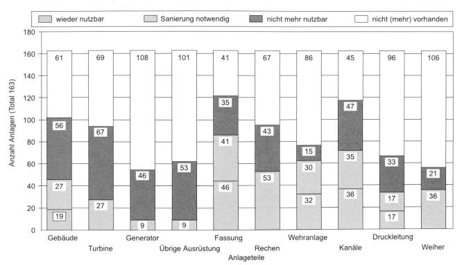
Bild 4. Zustand der jeweiligen Anlageteile der Anlagen mit einem ausgewerteten Erhebungsbogen.
