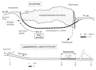
Bild 1. Lage der Teststrecke im Geschiebeumleitstollen Runcahez. Die einzelnen Testfelder sind jeweils 10 m lang und erstrecken sich über die ganze Stollenbreite.
