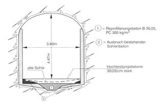
Bild 4. Querprofil in der Teststrecke.
