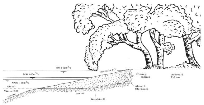
Bild 6. Flachufer-Normalprofil der Ufer-Renaturierung Rüdlingen (SH).
