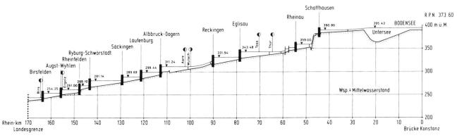
Bild 2. Übersicht über die Wasserkraftwerke am Hochrhein.
