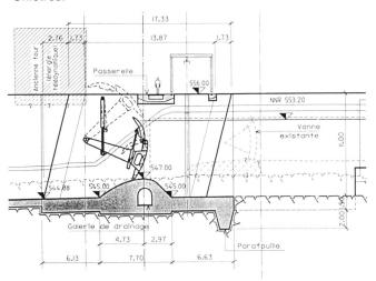
Figure 2. Evacuateur projeté - coupe longitudinale.
