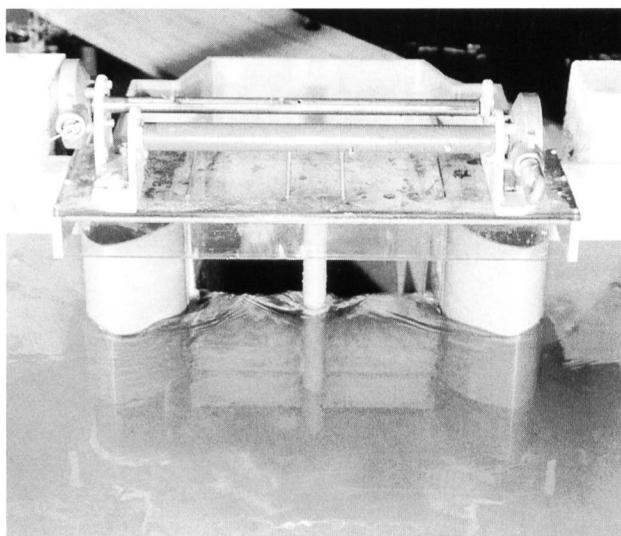
Figure 4. Modèle réduit de l'ouvrage d'entrée du nouvel évacuateur de crues.
