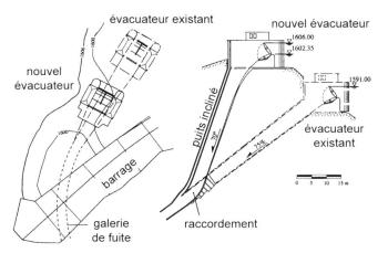
Figure 3. Situation et profil en long de l'ancien et du nouvel évacuateur.
