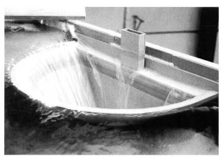
Figure 3. Modèle réduit: du déversoir semi-circulaire.
