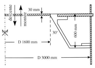
Figure 3. Coupe longitudinale du diaphragme.
