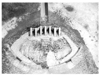
Figure 4. Variante de dissipateur testée.
