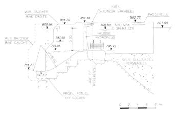
Figure 2. Coupe A-A de l'évacuateur en rive gauche.
