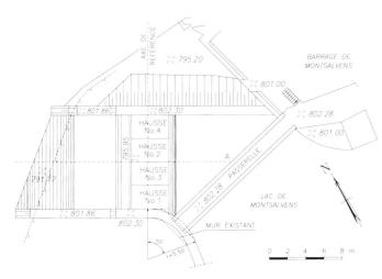
Figure 1. Vue en plan de l'évacuateur en rive gauche.
