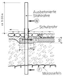
Bild 4. Stahlpfahl als Rechenstab mit den wirkenden Kräften.
