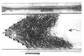
Bild 5. Modellversuche von Prof. Dr. *Jost Knauss:* Holzrückhalt im V-förmigen Fang (Draufsicht auf den Treibholzteppich).
