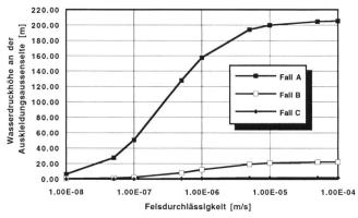
Bild 7. Wirksamer Wasserdruck an der Aussenseite der Betonauskleidung in Abhängigkeit der Felsdurchlässigkeit unter Berücksichtigung einer injizierten Felszone mit geringerer Durchlässigkeit.
