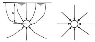
Bild 4. Strömungsbild bei einem nahezu horizontalen Stollen (links) oder bei einem vertikalen Schacht (rechts).
