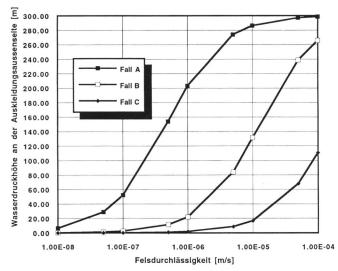
Bild 5. Wirksamer Wasserdruck an der Aussenseite der Betonauskleidung in Abhängigkeit der Felsdurchlässigkeit (ohne injizierte oder aufgelockerte Felszone).
