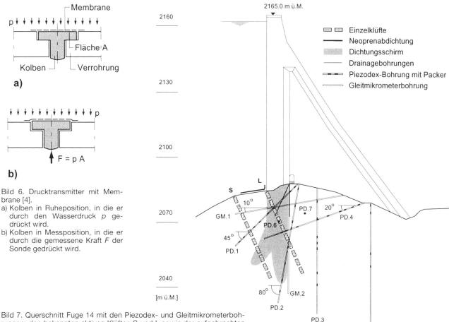
Bild 7. Querschnitt Fuge 14 mit den Piezodex- und Gleitmikrometerbohrungen, den bekannten aktiven Klüften S und L sowie der aufgebrachten Neoprenabdichtung.
