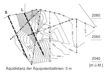
Bild 10. Aus den Piezodexmessungen konstruierte Potentiallinien bei einem Seestand von 2161 m ü.M. (Ablesung vom 17. Oktober 1988) [3].
