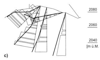
Bild 14. Vergleich der Mess- und Berechnungsresultate für drei verschiedene Modelle unter Vollstau (2162 m ü.M.): a) bei einem homogenen, isotropen Kontinuum, b) bei einem Kontinuum mit unbegrenzt ausgedehnten Kluftscharen, c) bei einem homogenen, isotropen Medium und den Klüften S und L [3].
