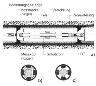
Bild 2. Funktionsschema des Gleitmikrometers (a) mit Gleitposition (b) und Messposition (c) [1].
