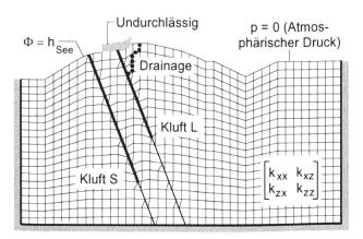
Bild 13. Geometrie, Randbedingungen und Netzeinteilung des Finite-Element-Modelles inkl. der zwei aktiven Klüfte S und L [3].
