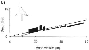
Bild 9. Schwankungsbreite der gemessenen Drücke in Funktion der Bohrlochtiefe für zwei verschiedene Bohrungen. Die beiden Geraden zeigen den hydrostatischen Druck bei maximalem (A) resp. minimalem Seestand (B). a) Messwerte bei maximalem Seestand in Bohrung PD.2. b) Messwerte bei minimalem Seestand in Bohrung PD.3.
