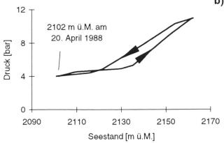
Bild 11. Zwischen April 1988 und Mai 1989 gemessene Werte für die Dehnung (a) resp. den Wasserdruck (b) in Funktion des Seestandes. Die Dehnung wurde in der Bohrung GM.1 in einer Tiefe von 46 m abgelesen, wo die Kluft S die Bohrlochachse schneidet. Die Wasserdrücke wurden an derselben Stelle gemessen wie bei Bild 8a.
