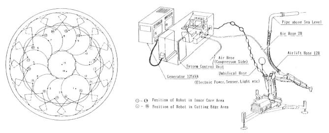
Bild 3. Ferngesteuerter Roboter für die Reinigung der Felsoberfläche in etwa 60 m Wassertiefe innerhalb des Caissons – Umsetzen und Arbeitsbereiche (unten links).
