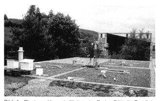
Bild 1. Plantener-Versuchsflächen in Baden-Dättwil: Begrünte Dachflächen müssen Regenwasser kurzfristig zurückhalten (Kurzzeitretention) und die Pflanzen langfristig mit ausreichend Wasser versorgen (Langzeitretention).
