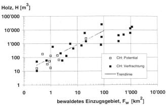
Bild 7. Schwemmholzpotential H, d.h. das im gerinnenahen Bereich herumliegende Wildholz, und Schwemmholzmengen H, die bei Hochwasserereignissen in der Schweiz verfrachtet wurden, in Abhängigkeit der bewaldeten Fläche des Einzugsgebietes  $F_{\text{w}}$ .
