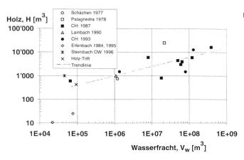
Bild 4. Schwemmholzmenge H, die bei Hochwasserereignissen verfrachtet wurde, in Abhängigkeit der Wasserfracht  $V_w$ .
