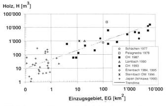
Bild 3. Schwemmholzmenge H, die bei Hochwasserereignissen verfrachtet wurde, in Abhängigkeit der Grösse des Einzugsgebietes EG.
