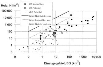
Bild 6. Schwemmholzpotential H, d.h. das im gerinnenahen Bereich herumliegende Wildholz, in Abhängigkeit der Fläche des Einzugsgebietes EG. Ebenfalls eingetragen sind die Schwemmholzmengen H, die bei Hochwasserereignissen in der Schweiz verfrachtet wurden (gleiche Daten wie in Bild 3).
