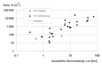
Bild 8. Schwemmholzpotential H, d.h. das im gerinnenahen Bereich herumliegende Wildholz, und Schwemmholzmengen H, die bei Hochwasserereignissen in der Schweiz verfrachtet wurden, in Abhängigkeit der bewaldeten Gerinnelänge  $L_{\infty}$ .
