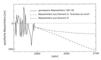
Bild 17. Verlauf der Massenbilanz: gemessen für die Periode 1961 bis 1995 und berechnet unter Annahme der IPCC-Temperaturszenarien (NFP31) A und D für die Periode 1995–2100.
