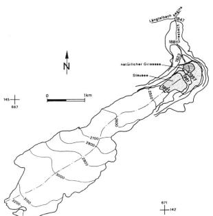
Bild 3. Karte des Griesgletschers mit Oberflächentopographie und Lage des Gletscherendes von 1847 bis 1991. Die verwendete Fliesslinie ist mit - · - · - bezeichnet.
