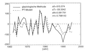
Bild 6. Massenbilanzen für den Griesgletscher von 1961 bis 1995 bestimmt mit der glaziologischen Methode sowie statistisch aus Temperatur- und Niederschlagsmessungen (PT-Modell).  $a_0$ ,  $a_7$  und  $a_N$  bezeichnen Koeffizienten des Regressionsmodells zwischen Klimafaktoren und Massenbilanz (siehe Kasten S. 114), rm ist der multiple Korrelationskoeffizient.
