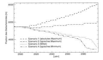
Bild 15. Evolution der Position der Gletscherzunge unter den vorgegebenen Massenbilanzszenarien 1 bis 4.
