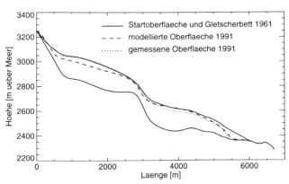
Bild 10. Vergleich zwischen modellierter und gemessener Oberfläche im Jahre 1991 im Längsprofil entlang der betrachteten Fliesslinie.
