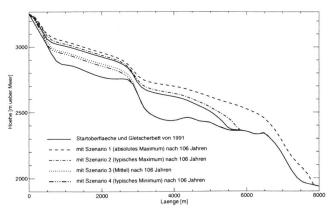
Bild 14. Evolution der Gletscheroberfläche 106 Jahre nach 1991 unter den vorgegebenen Massenbilanzszenarien 1 bis 4.
