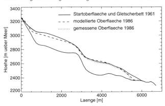
Bild 9. Vergleich zwischen modellierter und gemessener Oberfläche im Jahre 1986 im Längsprofil entlang der betrachteten Fliesslinie.
