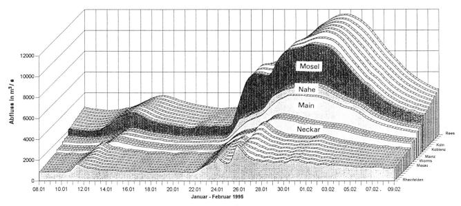
Bild 2. Hochwasserabflüsse des Rheins im Januar und Februar 1995. Überlagerung mit den Abflüssen aus den Zubringern Neckar, Main, Nahe und Mosel nach BfG, 1995.
