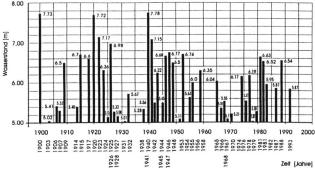
Bild 1. Hochwasserstände von 1900 bis 1995. Oben am Pegel Rhein-Köln (höher als 9 m), unten am Pegel Elbe-Dresden (höher als 3 m) nach *Kleeberg*. 1996.
