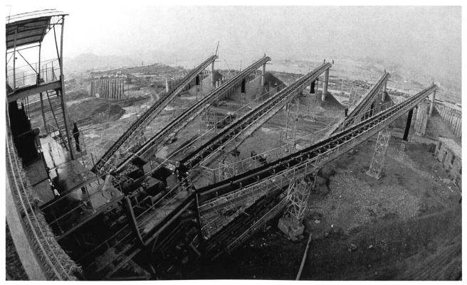
Bild 9. Zuschlagstofflager für die Betonbereitung.
