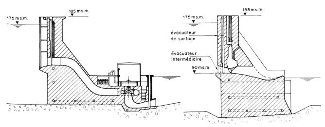
Bild 4. Querschnitt der Staumauer im Kraftwerksbereich (nach [9]).
