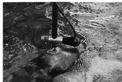
Bild 1, links. Magnetisch-induktive Strömungssonde Nautilus C 2000 der deutschen Firma Ott Messtechnik GmbH Co., Kempten. Diese Sonde ist bei der LHG-Messstation Gürbe-Burgistein installiert.
