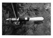
Bild 1, links. Magnetisch-induktive Strömungssonde Nautilus C 2000 der deutschen Firma Ott Messtechnik GmbH Co., Kempten. Diese Sonde ist bei der LHG-Messstation Gürbe-Burgistein installiert.
