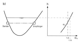
Bild 1. Schematische Darstellung eines Flussquerschnitts. a) Abhängigkeit des Abflussquerschnitts F vom Wasserstand h sowie Abhängigkeit der relativen Oberflächengeschwindigkeit im Schnitt SS vom Wasserstand h (für  $h=h_{\rm p}$  ist  $\alpha_{\rm 0}=0,95$ ); b) Abhängigkeit der relativen Geschwindigkeit  $\alpha_{\rm u}$  zwischen Sender und Empfänger vom Wasserstand h.
