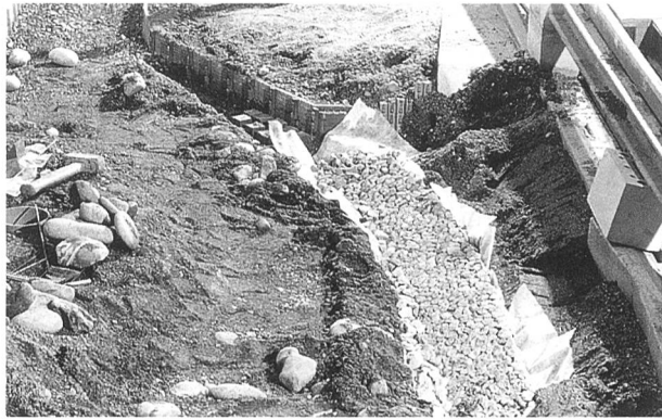
Bild 7. Anordnung des Geotextils im Modell.
