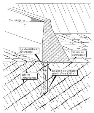
Erosionsgefährdete Bereiche im Untergrund einer Talsperre (Stahlmann).
