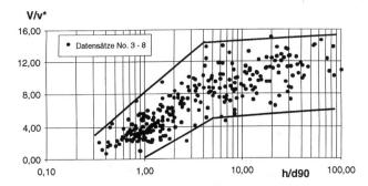
Bild 3. Der Kehrwert des *Darcy-Weisbach*-Reibungsbeiwertes,  $1/f = V/v^*$  in Abhängigkeit der relativen Abflusstiefe  $h/d_{90}$ . Zur Verdeutlichung des generellen Verlaufs sind die Umhüllenden approximativ eingezeichnet. Im Bereich  $h/d_{90}$  zwischen 3 und 5 zeigt sich ein Knick in der Beziehung zwischen  $V/v^*$  und  $h/d_{90}$ .
