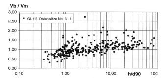
Bild 10: Verhältnis von berechneter zu gemessener Fliessgeschwindigkeit,  $V_{\rm b}/V_{\rm m}$ , in Abhängigkeit der relativen Abflusstiefe  $h/d_{90}$  für Gleichung (1).
