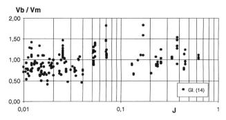
Bild 9. Verhältnis von berechneter zu gemessener Fliessgeschwindigkeit,  $V_{\rm b}/V_{\rm m}$ , in Abhängigkeit des Gerinnegefälles J für Gleichung (14). Für die Daten mit Gefällen  $J \ge 5\,\%$  besteht die beste Übereinstimmung.
