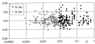
Bild 4. Verhältnis von berechneter zu gemessener Fliessgeschwindigkeit,  $V_{\rm b}/V_{\rm m}$ , in Abhängigkeit des Gerinnegefälles J. Man beachte, dass je nach Gefällsbereich zwei verschiedene Gleichungen angewendet werden.
