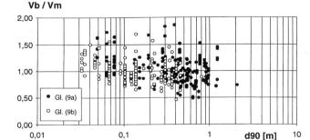
Bild 5. Verhältnis von berechneter zu gemessener Fliessgeschwindigkeit,  $V_{\rm b}/V_{\rm m}$ , in Abhängigkeit der charakteristischen Korngrösse  $d_{90}$ . Die Gleichung (9a) für steilere Gefälle ( $J \ge 0,008$ ) zeigt eine leichte Tendenz zur Überschätzung der Geschwindigkeit bei kleinen  $d_{90}$ .
