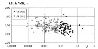
Bild 7. Verhältnis von berechnetem zu gemessenem *Strickler*-Wert,  $k_{\text{St,b}}/k_{\text{St,m}}$ , in Abhängigkeit des Gerinnegefälles J für die Gleichungen (12). Vor allem für den steileren Gefällsbereich ( $J \ge 0,008$ ) ergibt sich eine leichte, systematische Unterschätzung nach Gleichung (12a).
