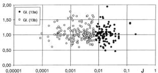
Bild 8. Verhältnis von berechnetem zu gemessenem *Strickler*-Wert,  $k_{\rm St,b}/k_{\rm St,m}$ , in Abhängigkeit des Gerinnegefälles J für die Gleichungen (13).
