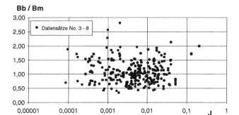
Bild 6. Verhältnis von berechneter zu gemessener (mittlerer) Gerinnebreite,  $B_{\rm b}/B_{\rm m}$ , in Abhängigkeit des Gerinnegefälles J.
