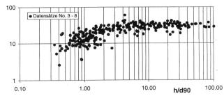
Bild 2. Strickler-Wert  $k_{\rm St}$  in Abhängigkeit der relativen Abflusstiefe  $h/d_{\rm 90}$ . Für Werte  $h/d_{\rm 90}$  kleiner als etwa 3 bis 4 nimmt  $k_{\rm St}$  deutlich ab.
