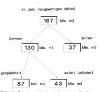
Bild 3. Das langjährige Mittel der Zuflüsse zum Becken Luzzone von 167 Mio m³ fällt zur Hauptsache im Sommer an (130 Mio m³). Nach der Staumauererhöhung können dann 67 Mio m³ gespeichert werden; vor der Erhöhung waren es 43 Mio m³.
