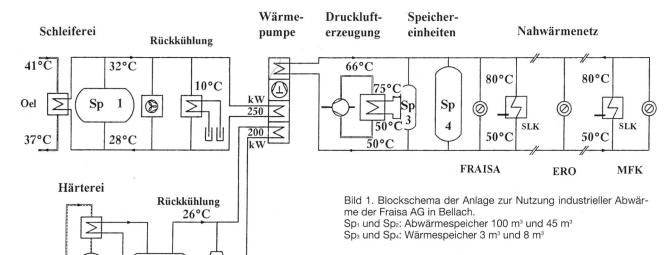
(8000 Liter) zwischengelagert. Das Heisswasser aus der Drucklufterzeugung (Abwärme grösser 75°C) gelangt nach einer Temperaturregelung direkt in einen weiteren, kleineren Speicher (3000 Liter). Die beiden Speicher sind hydraulisch miteinander verbunden. Sie werden durch die Zentralsteuerung übergeordnet bewirtschaftet.
