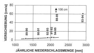
Bild 6. Zusammenhang zwischen Gleitbewegung und Niederschlägen.
