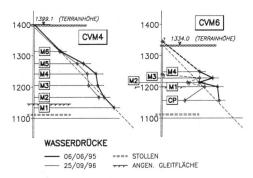
Bild 9. Wasserdrücke im Untergrund längs des Stollens zwischen Metrierung 700 und 1810 (obere Abbildung) und Wasserdruck in verschiedenen Messpunkten der Sondierbohrungen Nr. CVM4 und Nr. CVM6 vor (6. Juni 1995) und nach (25. September 1996) der Ausführung der Drainagebohrungen (untere Abbildung).
