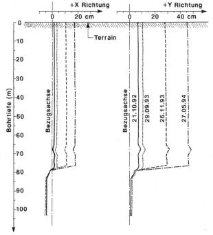
Bild 5. Mit Inklinometermessungen ermittelte Verschiebungen (Periode von 21. Oktober 1992 bis 27. Mai 1994) in der Sondierbohrung Nr. CVM6, wobei die X-Richtung ein Azimut von 118 Gon aufweist und die Y-Richtung 218 Gon.
