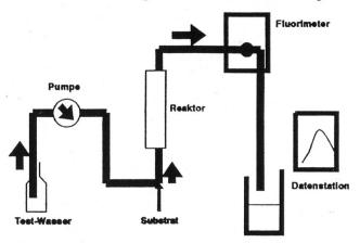
Bild 1. Halbautomatisierte Messung mikrobieller Enzymaktivitäten im Durchflussverfahren.
