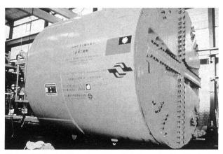
Bild 1. Erddruckschild mit 6,26 m Durchmesser für das Baulos CC560 der Metro Taipei (Herrenknecht GmbH, Schwanau/D).
