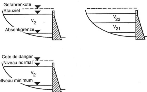
Fig. 4.4. Conversion d'une retenue à but unique en une retenue à buts multiples.
