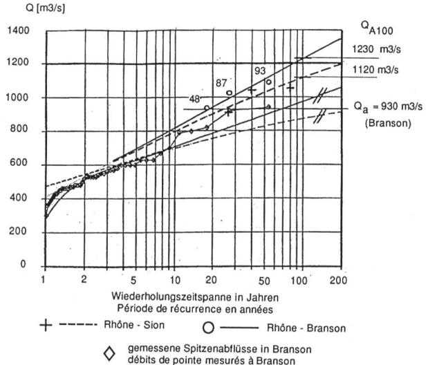
Fig. 3.31. Statistique des débits de pointe du Rhône aux stations hydrométriques de Sion et de Branson.
