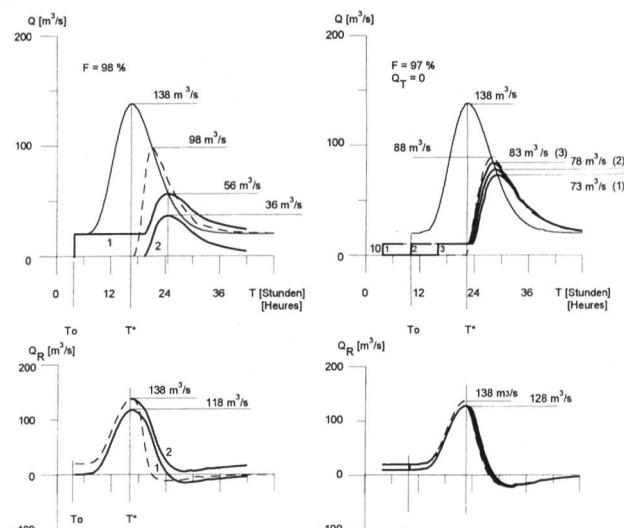
Fig. 4.3. Effet d'une régulation de retenue.
