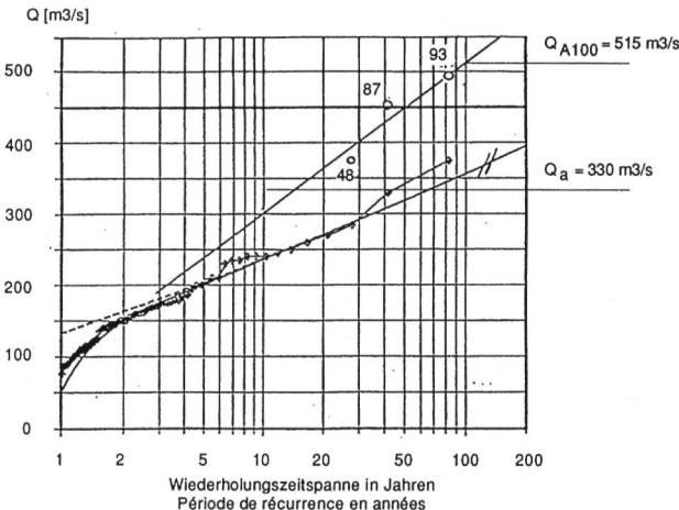
Fig. 3.33. Statistique des débits de pointe de la Vièze à la station hydrométrique de Vièze.
