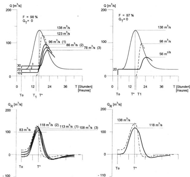
Bild 4.2. Einfluss einer Speicherregulierung in Abhängigkeit der Regulierwassermenge und des Füllungsgrads des Speichers zu Beginn des Hochwassers.
