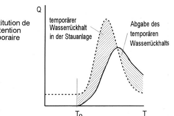
Bild 3.9. Transformation des Hochwassers in einem Speicher, wenn dieser zu Beginn voll gefüllt ist.
