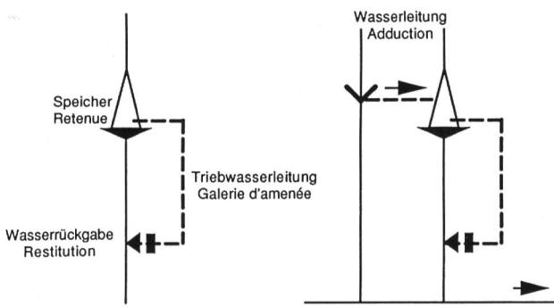
Fig. 3.1. Aménagement hydro-électrique à accumulation – schéma de principe.
