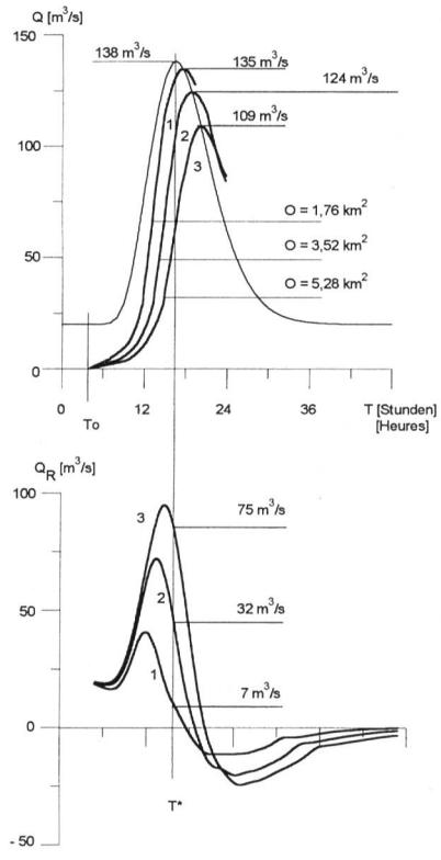
Fig. 3.16. Influence de la superficie du plan d'eau sur le débit sortant  $Q_A$  et le débit stocké  $Q_R$  (retenue de Mattmark – crue idéalisée de 1993; pas de turbinage – superficie effective du plan d'eau:  $1,76 \text{ km}^2$ ).
