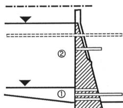
Fig. 3.5. Organes permettant de soutirer ou d'évacuer l'eau d'une retenue.
