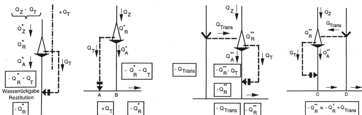
Fig. 3.18. Effet du turbinage.
