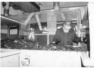
Bild 1. In der Sortierkabine werden Störstoffe aus dem Bioabfall manuell ausgelesen. Der Arbeitsplatz ist mit einer Absaughaube versehen, um den Sortierer vor Gerüchen und Keimen zu schützen.
