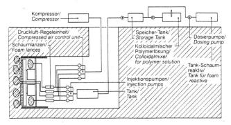
Bild 1. Aufbau der Schaumanlage und Installation auf dem Nachläufer des Vortriebsschildes.
