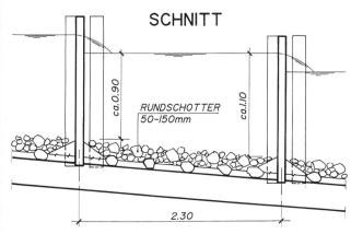
Bild 1. Grundriss (oben) und Schnitt (unten) durch die ausgeführten Vertical-Slot-Fischpässe.
