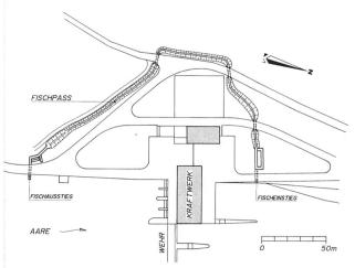
Bild 2. Lage des Kraftwerks Aarberg mit Fischpass.
