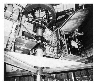
Bild 1. Für Birsfelden konstruierte Laufradmantel-(Kugelform-) Ausdrehvorrichtung, Durchmesser 7200 mm.
