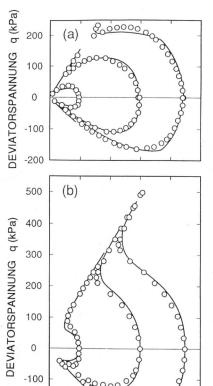
Bild 3, links. Silt mit drei verschiedenen Seitendrücken im Triaxialversuch (Berechnung Linien, Triaxialversuch Punkte) a) lockere Lagerung, b) dichte Lagerung
