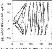
Bild 4, rechts. Lockerer Sand bis zur Verflüssigung zyklisch beansprucht (Berechnung Linien, Triaxialversuch Punkte).
