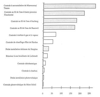
Figure 1. Facteurs de gain de 12 centrales de production. Les barres hachurées se rapportent à des aménagements qui produisent de l'électricité au moyen d'énergies renouvelables.
