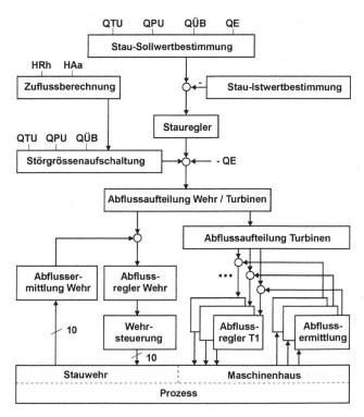
Bild 5. Regelschema zur Stauregelung (Grafik: nach Beltzig).
