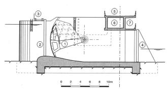
Bild 4. Schnitt durch das Wehr.
