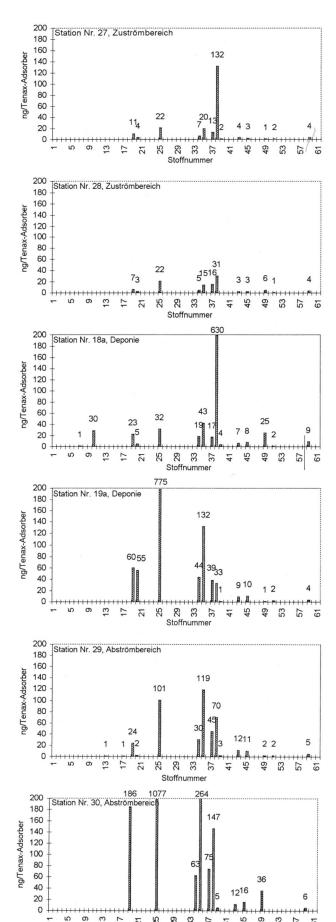
Bild 2. Messprofil durch die Deponie. Die Stoffe Nr. 19 (Benzol), 25 (Toluol), 34 (Ethylbenzol), 35 (m+p-Xylol), 37 (o-Xylol) und 38 (Styrol) sind dominant und typisch für Ölrückstände.
