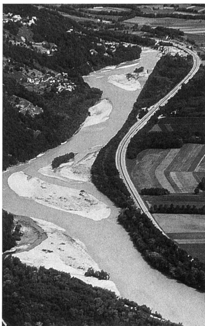
Bild 5, links. In verzweigten Flüssen können die Uferbelastungen lokal wesentlich grösser sein als in kanalisiertem Abschnitt. Für den Uferschutz können ingenieurbiologische Bautechniken deshalb nicht mehr angewandt werden. An ihre Stelle treten «harte» Verbauungsmassnahmen wie Blockwürfe und Buhnen. Dennoch sind gerade derartige Gebiete ökologisch ausgesprochen wertvoll.
