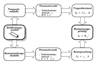
Bild 8. Bemessungskonzept. Die Zuverlässigkeitstheorie findet Eingang in alle Ingenieurdisziplinen. Die Bemessungsphilosophie wird vereinheitlicht (Eurocode 1), indem aufgrund von Gefährdungsanalysen Einwirkungen definiert werden. Die Beanspruchungen und Widerstände werden systematisch in einem Denkmodell integriert.
