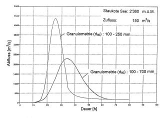
Bild 8. Beispiele von Ablaufberechnungen. Die Ausflussspitze durch eine Dammbresche hängt von der Kornverteilung des Dammkörpers ab. Feinkörniges Dammaterial wird rascher erodiert als grobkörniges.
