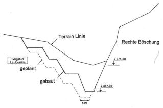
Bild 7. Geplanter und ausgeführter Überlaufkanal durch den Bergsturzdamm zur Ableitung des Sees.
